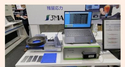
▲ 焼入れ部品(ギア)の硬さを非破壊検査するデモ。画期的な精度での非破壊検査を実現している硬さ以外の検査への適用も進んでいる
